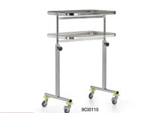
9CI0115 Tavolo servitore a tunnel, struttura completamente in acciaio Inox AISI 304. Regolazione in altezza ogni mm 50 con volantini di bloccaggio. Piano asportabile a vassoio stampato, di contenimento liquidi. Ruote paracolpi e basamento con 4 ruote antistatiche, diametro mm 80, di cui due con freno. Dimensioni: mm 900 x 580 x 980/1400 h Over-bed serving table made entirely from AISI 304 stainless steel. Height adjustable in 50 mm steps with blocking nuts. Removable top with a moulded tray which contains liquids. Shockproof wheels and base with four 80 mm diameter antistatic castors, two braked. Dimensions: mm 900 x 580 x 980/1400 h
