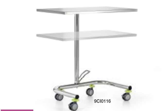
9CI0116 Carrello portastrumenti chirurgici, oleodinamico, piano in acciaio Inox AISI 304. Colonna con sollevatore oleodinamico a pedale. Basamento in acciaio Inox AISI 304 con quattro ruote gemellari antistatiche diametro mm 80 di cui due con freno. Dimensioni: mm 1200 x 650 x 900/1250 h Hydraulic surgical instrument cart with AISI 304 stainless steel top. Pedal-operated hydraulic stand. AISI 304 stainless steel base with four 80 mm diameter antistatic twin swivel castors, two braked. Dimensions: mm 1200 x 650 x 900/1250 h
